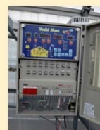
試作した環境制御機器 (YoshiMax)
