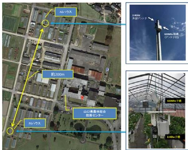
図 2 山口県農林総合技術センターの A6-地域 6 ハウス間の到達試験状況
